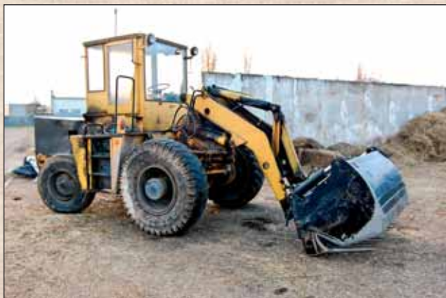
Na tomto nakladači je namontovaný vykrajovač blokov siláže.
