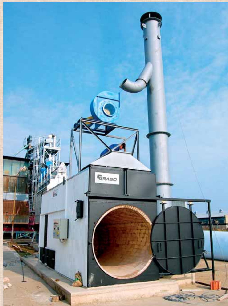
V čase našej návštevy dokončovali sušičku na obilie vykurovanú veľkými balíkmi slamy.
