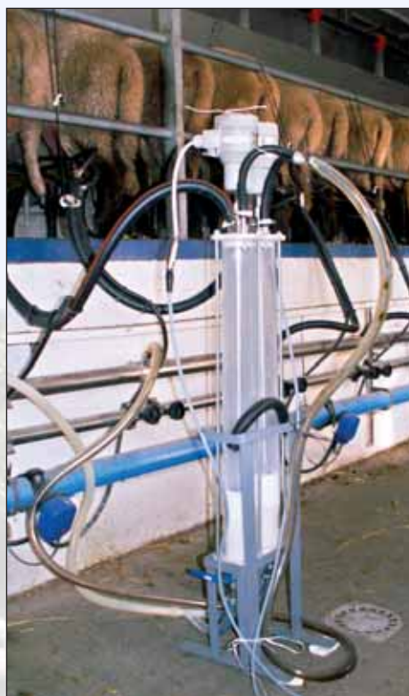
Obr. č. 1: Zloženie prístroja na meranie intenzity toku mlieka
